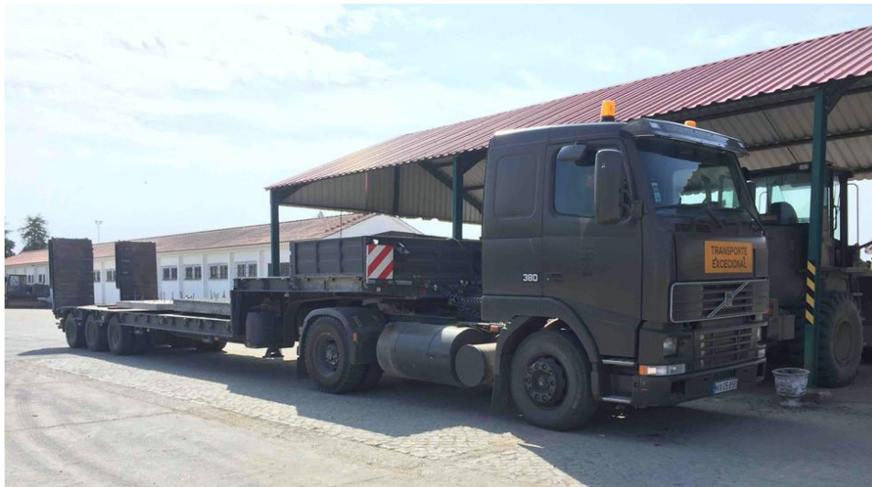
Figura 27 - Plataforma utilizada para o transporte das lajes
