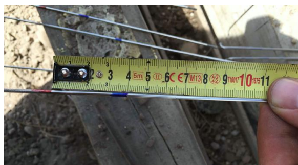
Figura 40 - Haste metálica para medição da deformação máxima
