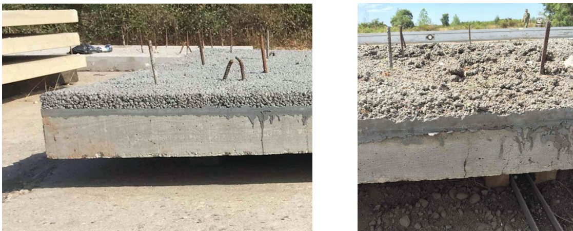
Figura 60 - Laje reforçada com UHPFRC e LWAC antes do ensaio (à esquerda) e após o ensaio (à direita)
