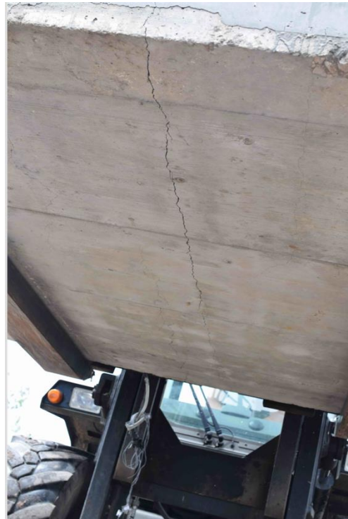
Figura 61 - Laje reforçada com UHPFRC, LWAC e RuC após ensaio
