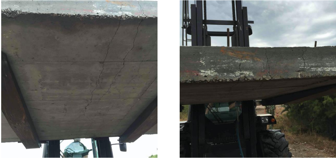
Figura 57 - Laje de referência após ensaio, vista inferior (à esquerda) e vista lateral (à direita)
